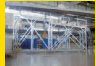
Dock d'accès bout de voilure Airbus A320 - designed by REEL
