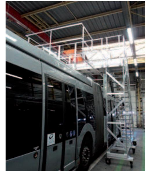
Plate-forme d'accès en toiture de bus - SMTD
