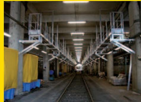
Passerelle de maintenance fixe de 2 x 90 m pour accès en toiture de trains - SNCF
