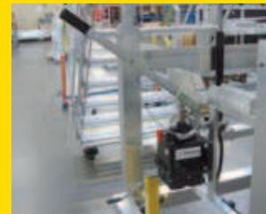
Pompe à main hydraulique permettant le réglage en hauteur des plate-formes
