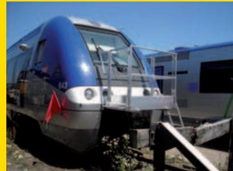
Plate-forme d'accès pare-brise motrice TER
