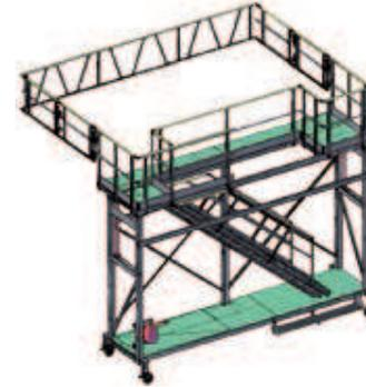
Passerelle mobile d'accès et de mise en sécurité des toitures de trains réglable en hauteur par pompe hydraulique - Alstom
