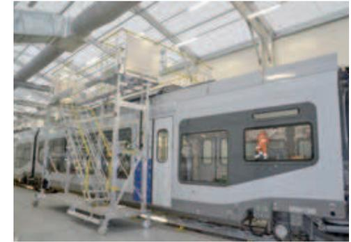
Passerelle mobile en situation, hauteur de plancher réglable de 3,46 à 4,46 m - Alstom
