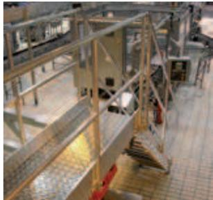
Passerelle et escalier sur chaîne d'embouteillage - Brasseries
