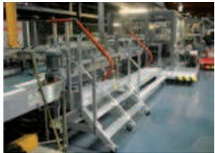
Plate-forme et escabeau mobile sur chaîne de montage
