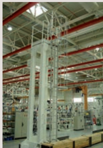
Crinoline pour accès en hauteur sur équipement industriel
